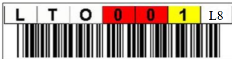
Figura 01 - Exemplo de etiqueta para fita LTO-8 tipo A.
