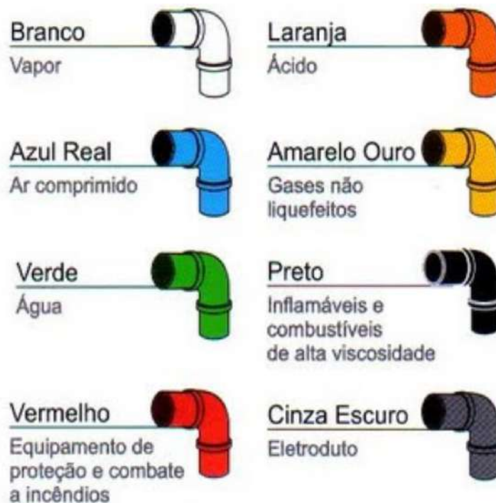
Figura 68 - Cores das Tubulações - NBR 6493 (Representação genérica)
