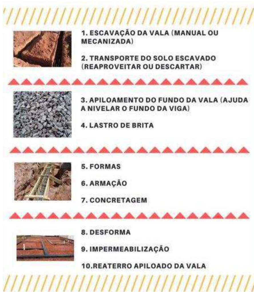
Figura 62 - Escopo de Viga Baldrame
