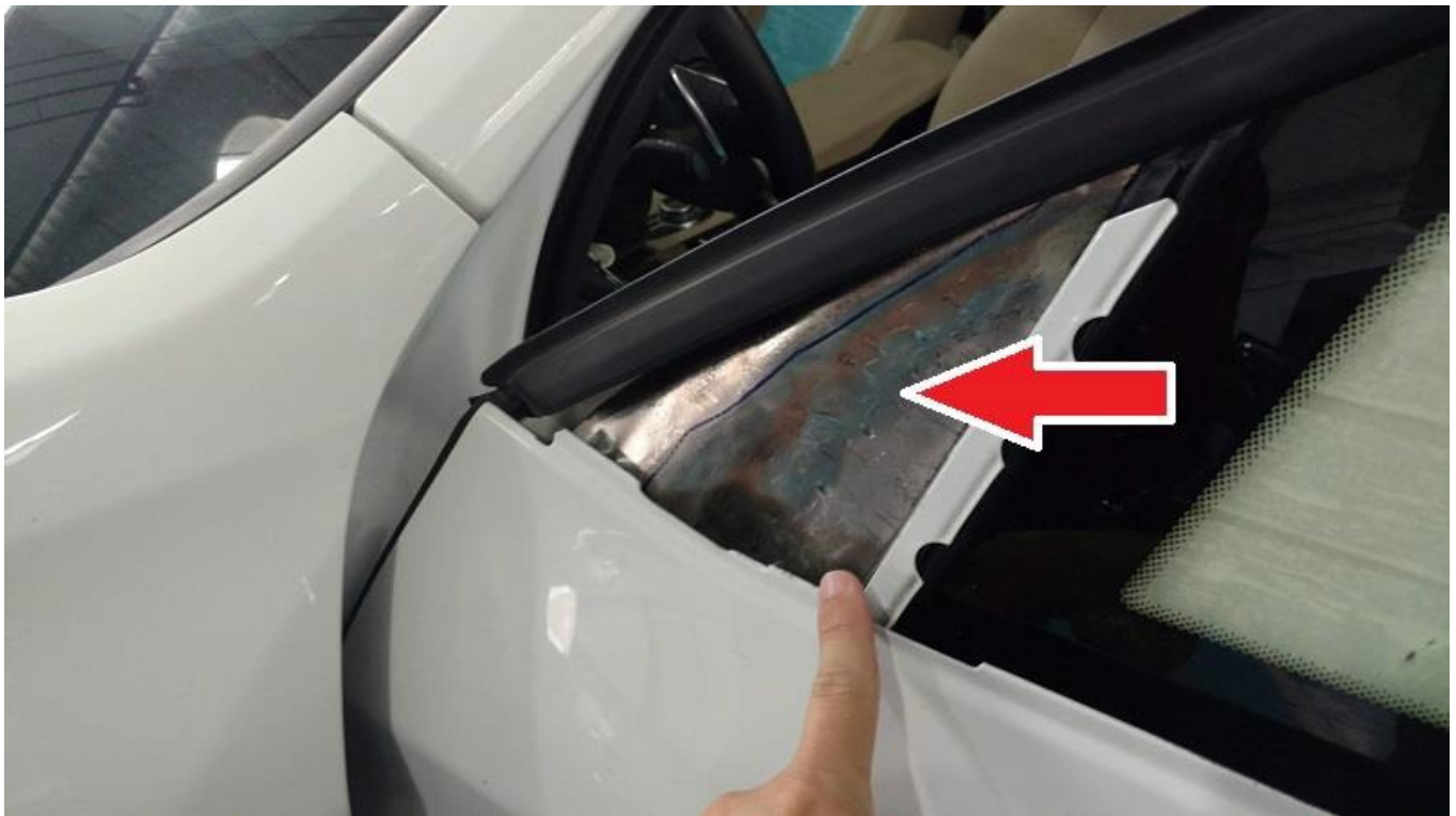
Figura 11 - Chapa de aço inox aplicada na região do retrovisor externo.
