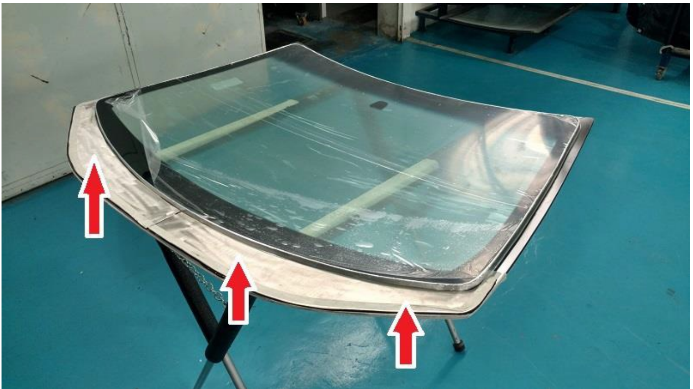
Figura 6 - Reforço em aço inox na região do offset (sorriso) do para-brisa
