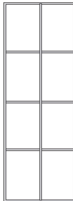
Estrutura interna em metalon 50 x 30mm -
